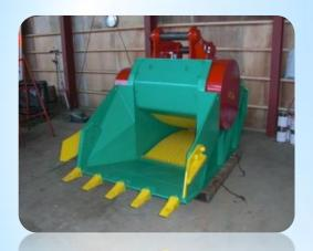
バックホウを動力源とした全機種取付け 可能な機械
