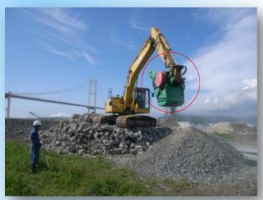
バックホウに装着し、再生骨材を製造
