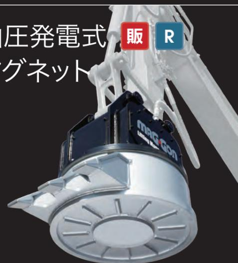
油圧発電式のリフティングマグネットです。取付は油圧ブレーカーと変わりませんので簡単に手早く脱着できます。発電機やバッテリー・制御盤の取付も不要です。
