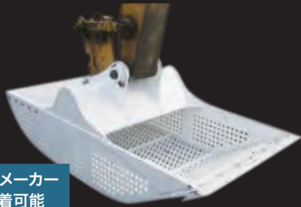
この機械は主に畑の徐レキや、骨材(砂利)の粉分などの除去などに用いるふるい分けバケットです。一度の掘削で大きな面積を処理できるため、面の仕事に適しており、舟形となっているため、強振してもこぼれ落ちることなく、強制的に排出作業ができます。
