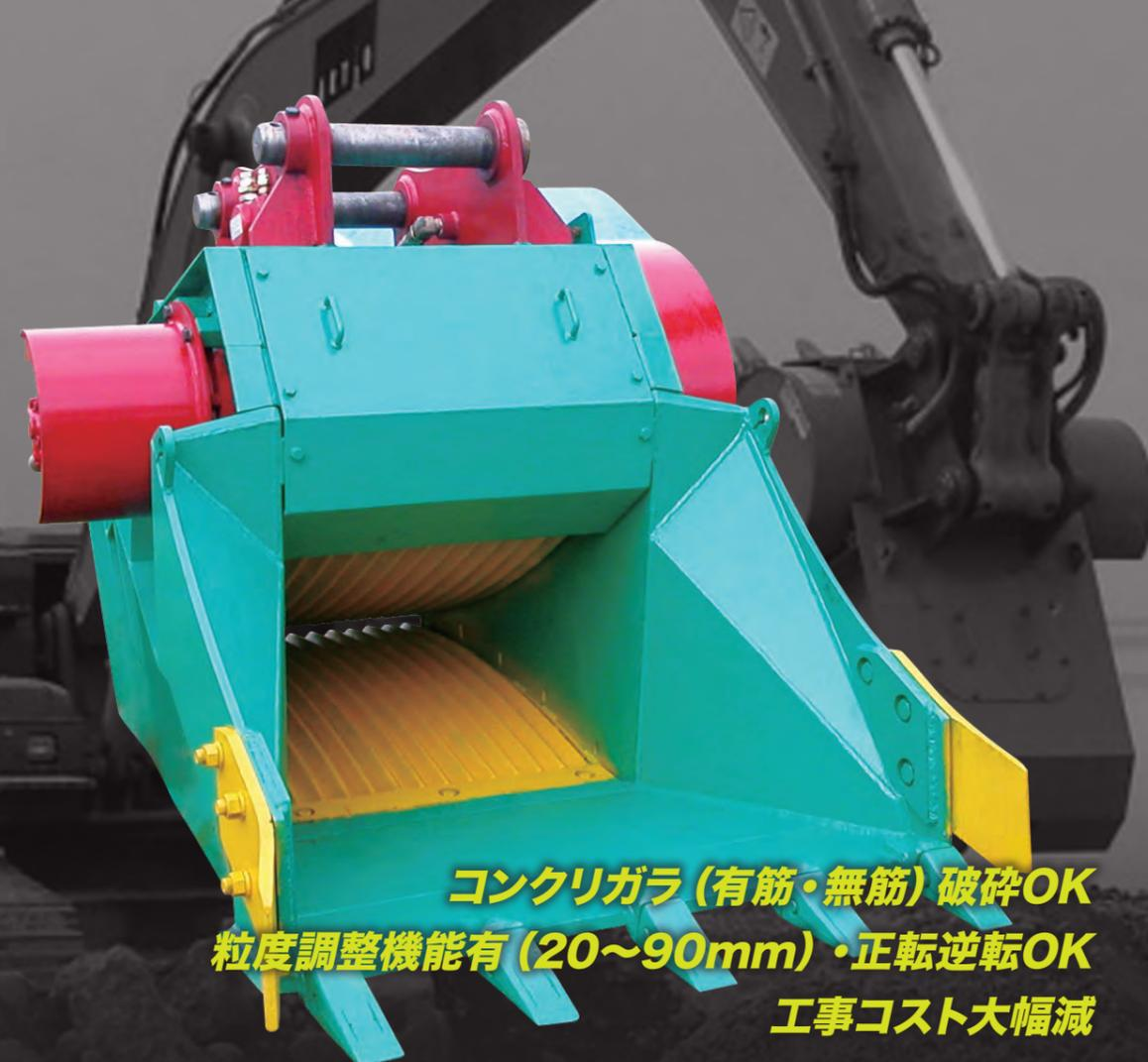
コンクリガラ(有筋・無筋) 破碎OK
