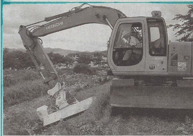
法面部での作業。この姿勢で固定し、車体を動かして作業できる
